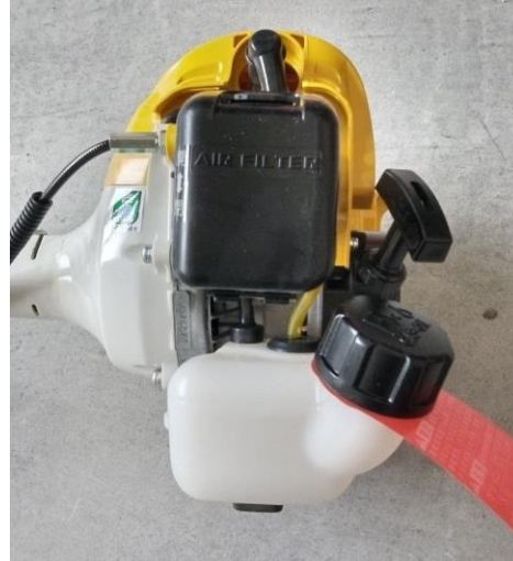
エンジン左側 （左から）チョークレバー、プライミングポンプ、燃料タンク、リコイルスターター
