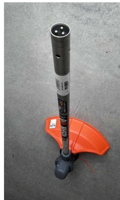
パイプ内 コンセント
