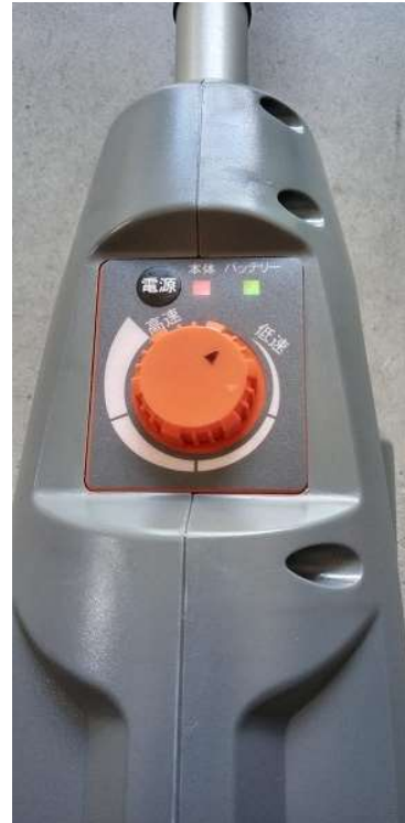
電源スイッチ、本 体・バッテリーラン プ、変速ダイヤル
